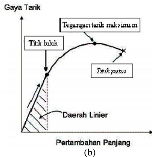
Gambar 3. (a). Skema deformasi bahan dan (b). Kurva gaya tarik terhadap pertambahan panjang bahan.
