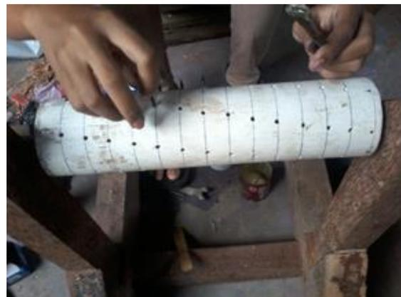
Gambar. 4. Proses pembuatan silinder berpaku.
