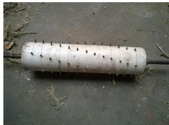
Gambar. 5. Proses pembuatan silinder berpaku.
