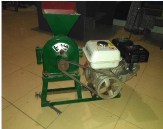
**Gambar 3.** Alat Pencacah Kulit kemiri atau serat
