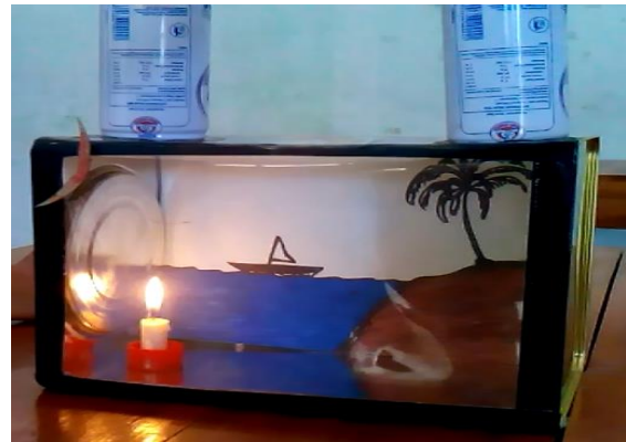
Gambar 5. Foto Cara kerja alat peraga terjadinya angin laut
