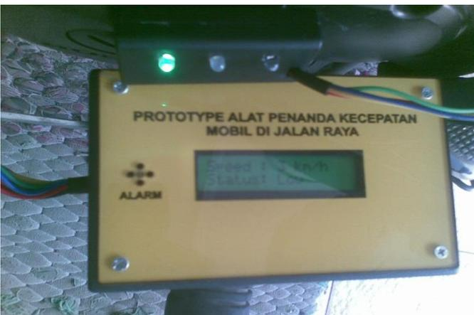
Gambar 7. Prototipe alat penanda kecepatan yang sudah jadi
