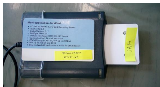
Gambar 6. Proses instalasi Applet Java Card menggunakan smart card reader
