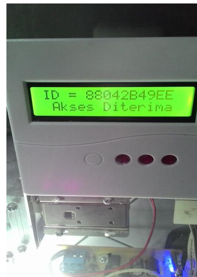
Gambar 9. Tampilan nomor ID E-KTP pada LCD 16x2
