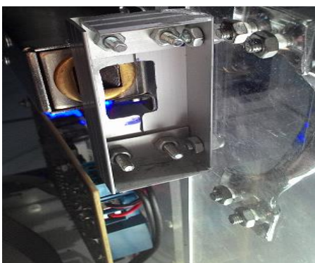
Gambar 8. Solenoid (on) membuka pengunci pintu
