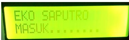
Gambar 7. LCD Menampilkan nama E-KTP pengakses pintu
