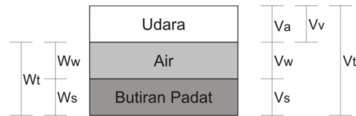
Gambar 1. Hubungan antara berat dan volume pada komposisi tanah
