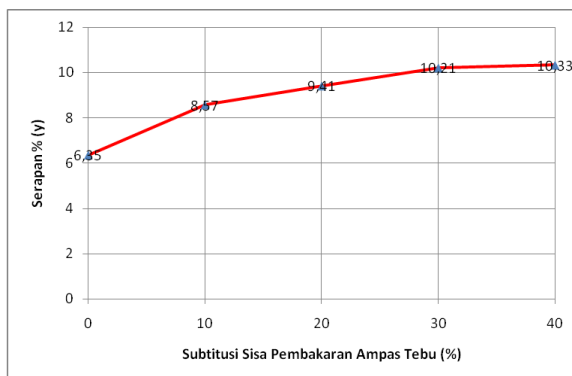
Gambar 9. Uji serapan air pada paving blok menggunakan semen PPC
