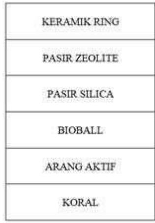
**Gambar 2.** Susunan BioFilter dalam Kolam Bawal
