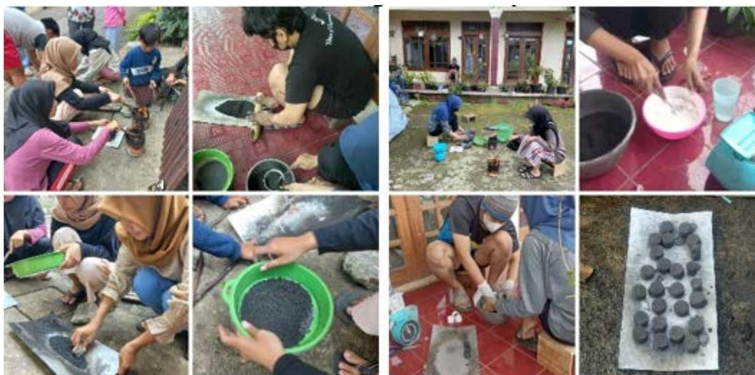
**Gambar 1.** Proses percobaan pembuatan briket bonggol jagung
