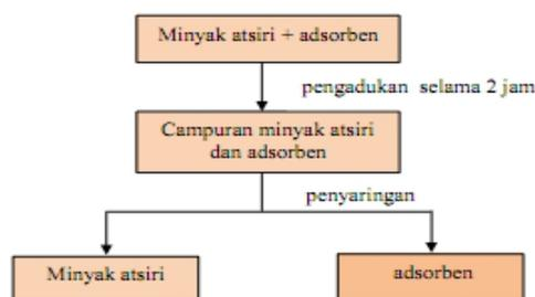
**Gambar 1. Diagram alir teknologi pemurnian dengan metode adsorpsi**
