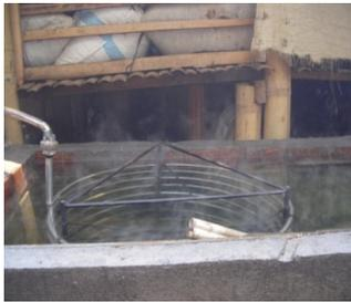
**Gambar 3. Kondensor bentuk spiral**
