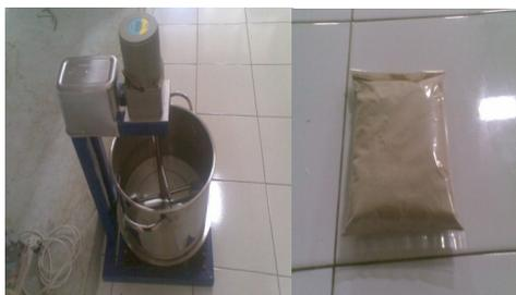
**Gambar 6. (kiri) Alat mixing untuk pemurnian minyak cengkeh, (kanan) bentonit**
