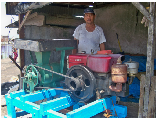
Gamba 2. Mesin giling terasi hasil program IbM
