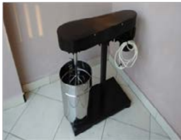
Gambar 6. Mesin Pengaduk Adonan Martabak Manis Siap Digunakan
