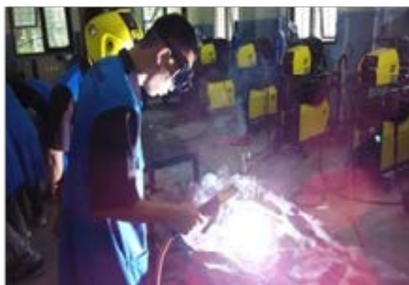
Gambar 5. Menyatukan Bagian Bagian Mesin Pengaduk Adonan Dengan Pengelasan
