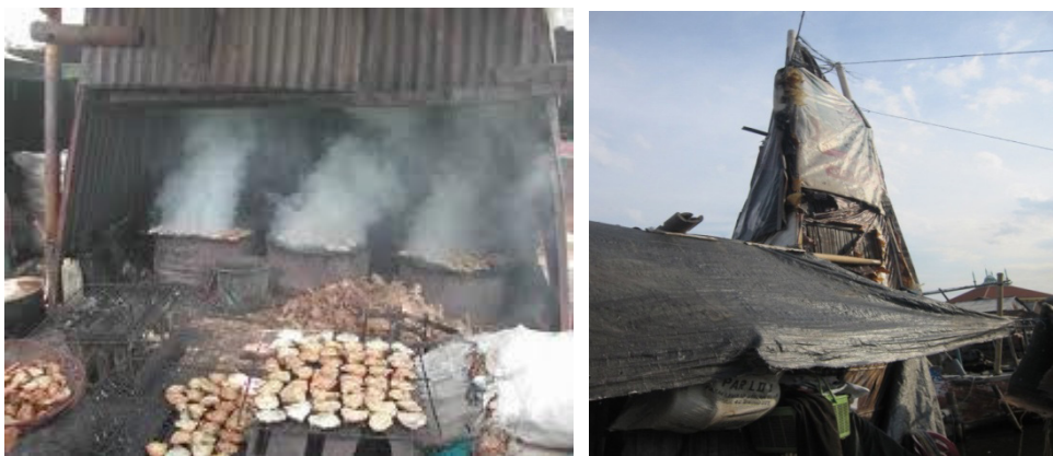
Gambar 1. Cara pemanggangan dan cerobong asap pengolahan ikan tradisional
