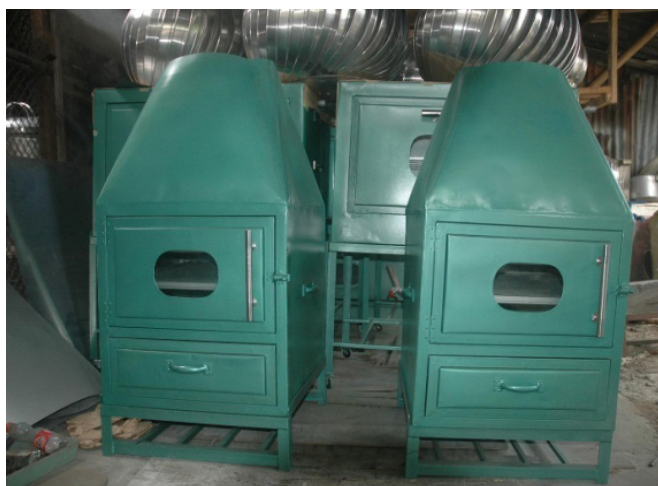
Gambar 4. Oven pemanggangan ikan hasil IbM
