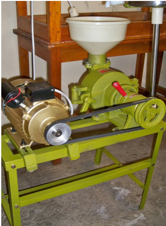
Gambar 3. Mesin penggiling kedelai dengan penggerak motor listrik
