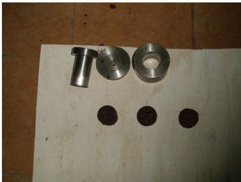
Gambar 4. Hasil cetakan briket yang berbentuk silinder dengan tinggi 5 cm dan diameter 5 cm
