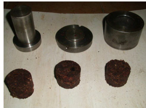
Gambar 4. Hasil cetakan briket yang berbentuk silinder dengan tinggi 5 cm dan diameter 5 cm
