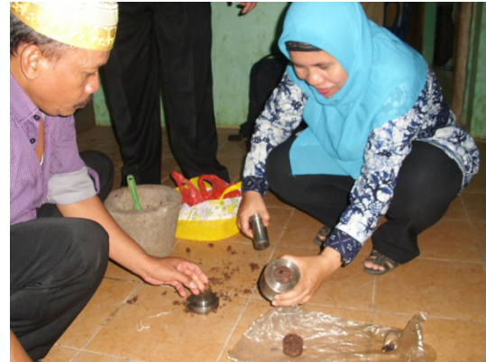
Gambar 3. Praktek pembuatan briket meenggunakan bahan dasar limbah kulit kolang-kaling dengan kegiatan awal melakukan (a) penumbuhkan kulit kolang-kaling dan (b) proses pencetakan dengan bentuk hasil berupa silinder
