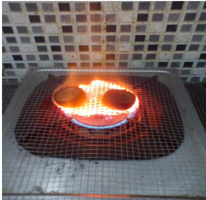
Gambar 2. (a). Proses uji laju pembakaran briket, (b). Serbuk sisa pembakaran
