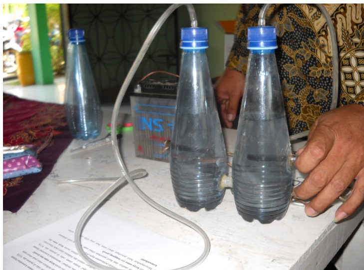
Gambar 2. Alat elektrolisis sederhana dari bahan bekas hasil produk proyek
