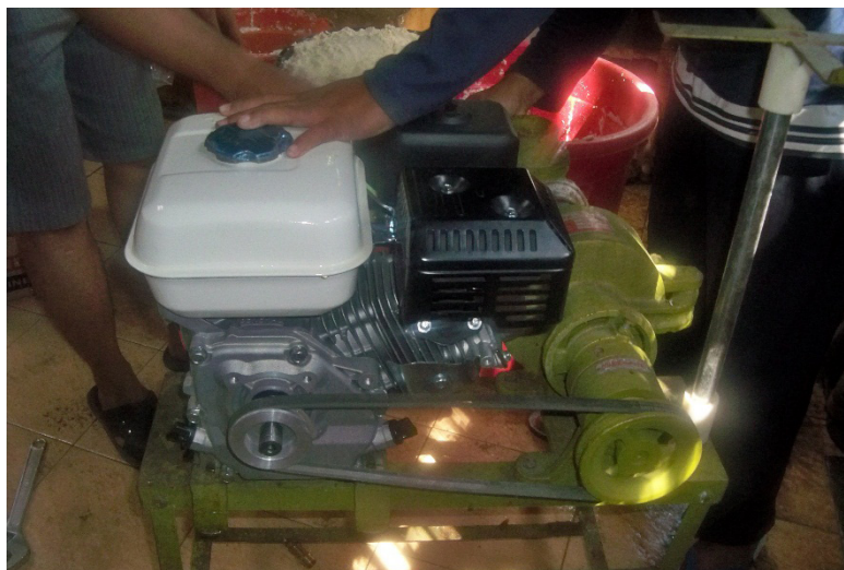
Gambar 2. Mesin penggiling kedelai penggerak motor bensin.
