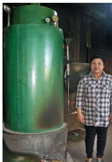
Gambar 4. Ketel uap untuk industri tahu yang telah dioperasikan
