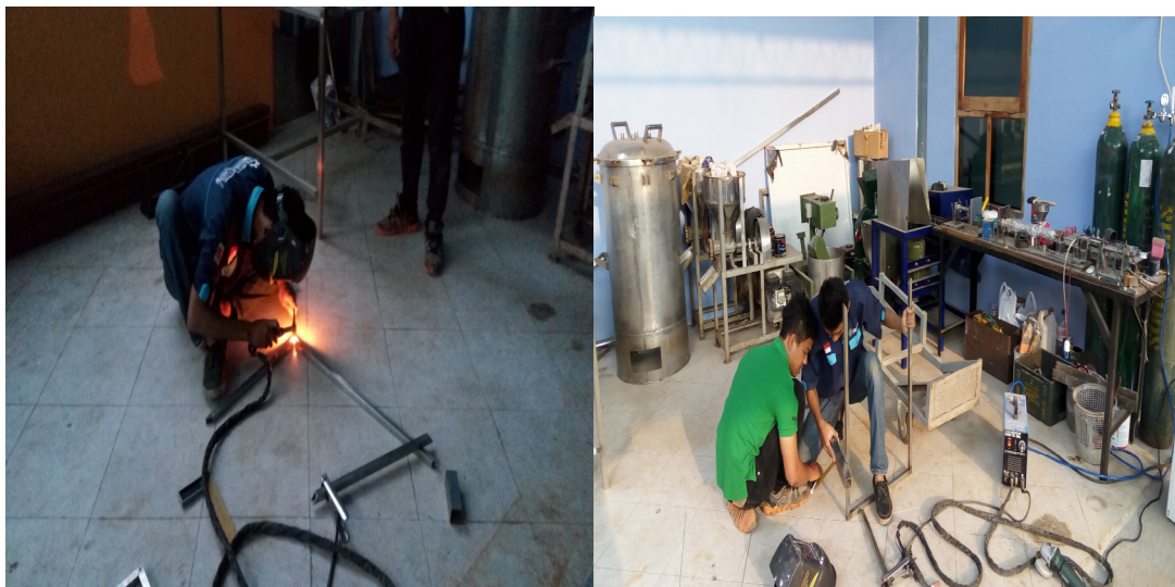
Gambar 6. Proses pengelasan rangka
