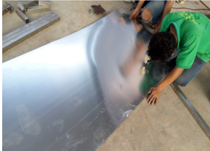
Gambar 5. Proses pemotongan plat aluminium
