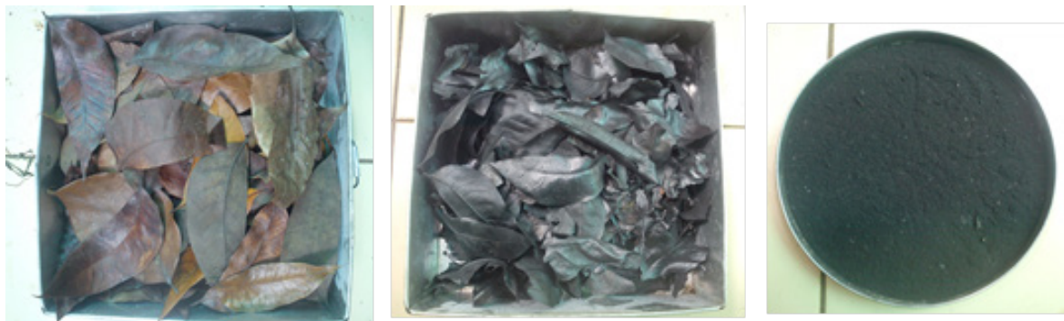
Gambar 1. (kiri/ a) Sampah daun, (tengah/ b) Arang daun, dan (kanan/ c) Serbuk Karbon
