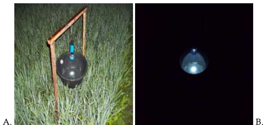
Gambar 4. Perangkap lampu dengan lampu senter LED 1 lampu (0,3 watt) dan wadah penampung (Ø 32 cm). (A) Alat perangkap lampu. (B) Cahaya lampu dari perangkap lampu.
