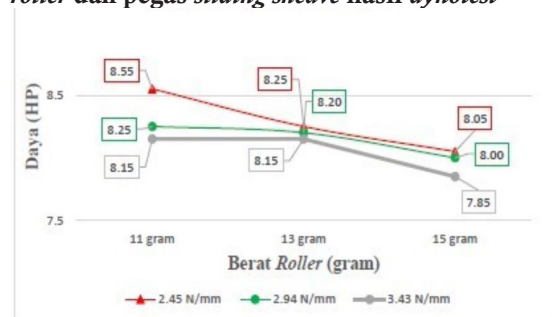
Gambar 1. 7 Grafik Daya pada rpm 3000 dengan Variasi Roller dan Pegas Sliding Sheave
