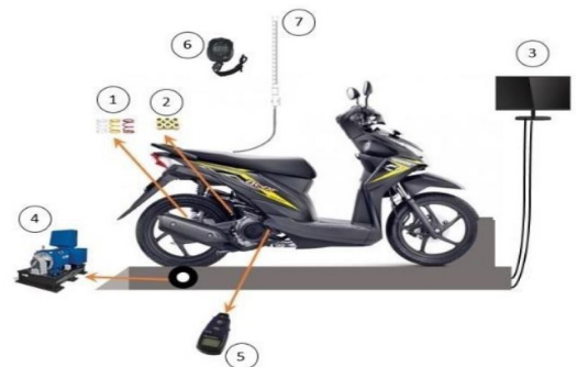
Gambar 1. 1 Skema Instalasi Pengujian Daya, Torsi, dan Konsumsi Bahan Bakar
