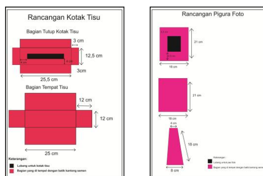
Gambar 11. Ukuran pola produk tempat tisu dan pigura foto (Sumber: Foto hasil rekaman peneliti)
