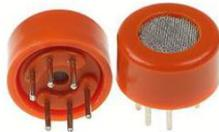
Gambar 3. Sensor alkohol MQ3 (Latupeirissa et al., 2015).
