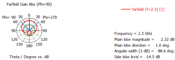
Gambar 22. Pola radiasi sudut elevasi antenna patch elips
