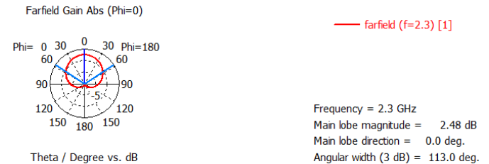
Gambar 9. Pola radiasi sudut azimuth antenna patch lingkaran
