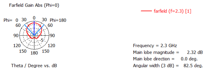
Gambar 21. Pola radiasi sudut azimuth antenna patch elips
