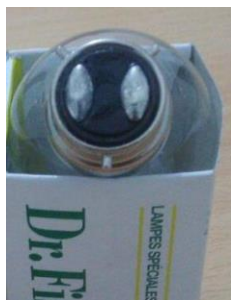
Gambar 15. Kondisi Plug Lampu Yang Masih Baik
