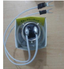
Gambar 16. Kondisi Plug Lampu Bohlam disolder dan dipasang kabel
