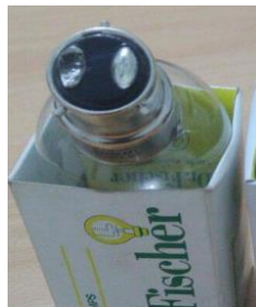
Gambar 14. Kondisi Plug Lampu Yang Sudah Rusak
