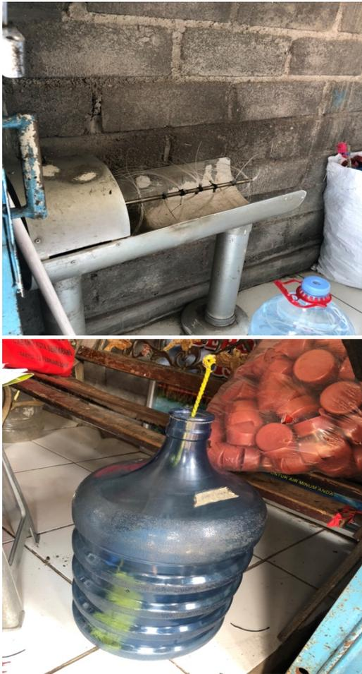
**Gambar 1.** Alat pencucian gallon yang tidak layak
