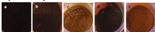
Gambar 1. (a) Magnetit , (b) HT-M, (c) HT-M kal, (d) HT-M pasca adsorpsi, dan (e) HT-M kal pasca adsorpsi
