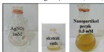
Gambar 2. Pengamatan visual proses sintesis nanopartikel perak
