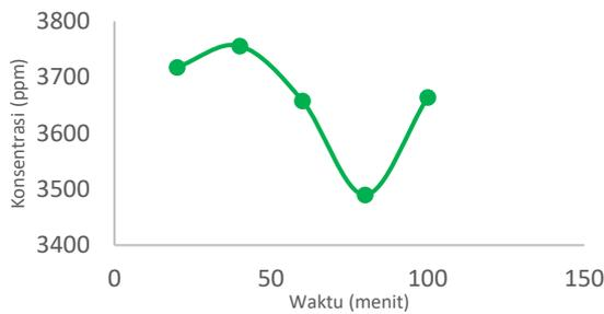
**Gambar 3.** Kurva pengaruh waktu elektrolisis terhadap konsentrasi nikel pada limbah elektroplating
