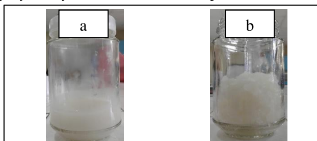
Gambar 7. Perbedaan wujud polimer berdasarkan penambahan MBA
