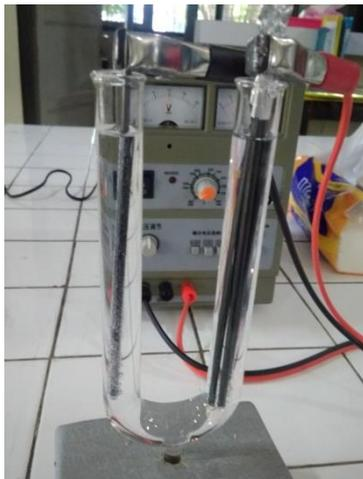
**Gambar 2.** Katoda mulai mengeluarkan gelembung gas dan anoda mulai terjadi pengelupasan
