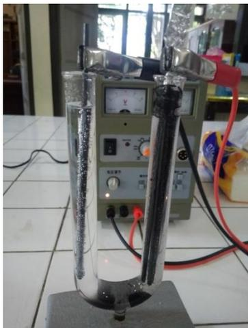
**Gambar 3.** Gelembung gas dan pengelupasan pada batang grafit semakin besar
