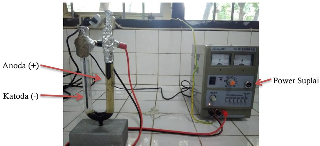
**Gambar 1.** Rangkaian pengelupasan elektrokimia
