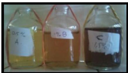
**Gambar 1.** Larutan koloid nanopartikel perak hasil sintesis dengan metode reduksi AgNO<sub>3</sub> dengan reduktor C<sub>6</sub>H<sub>5</sub>O<sub>7</sub>Na<sub>3</sub> 0,5% (A); 1,0% (B) dan 1,5% (C)
