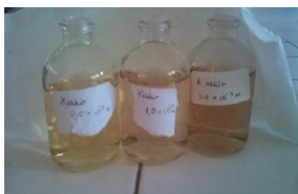
Gambar 1. Koloid nanopartikel perak menggunakan metode reduksi dengan variasi konsentrasi \text{AgNO}_3
