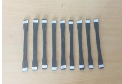
Gambar 1. Benda uji berbentuk gagang/stik 16×2 cm
