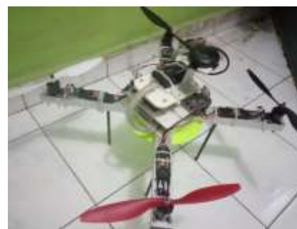
Gambar 12. Hasil implementasi pemasangan komponen dan kerangka
