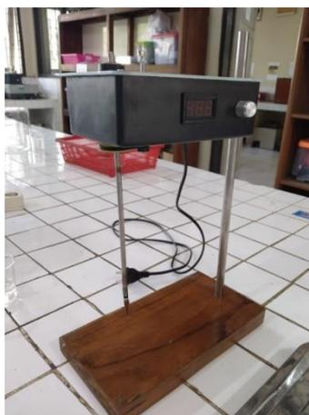
**Gambar 1.** Alat *spin coating* Modifikasi Khusus Buatn Sendiri
