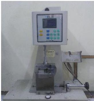
Gambar 9. Alat uji impak charpy
