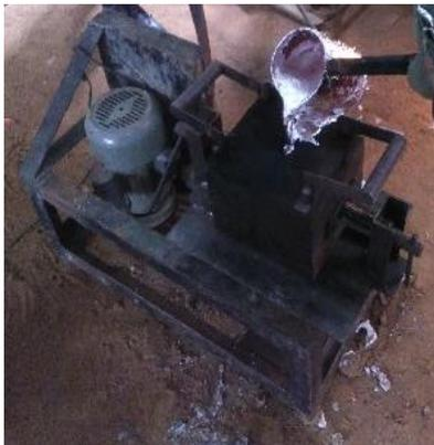
Gambar 4. Mesin pengecoran sentrifugal tegak
