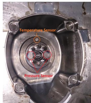
Gambar 1. Posisi Sensor didalam cetakan
