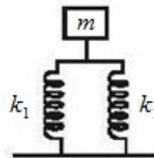
Gambar 1. *Double shockbreaker* merupakan analogi dari susunan paralel pegas
