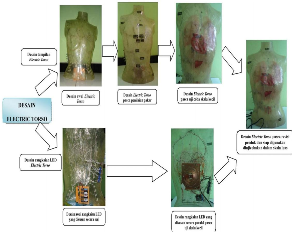
**Gambar 2** Foto series proses pengembangan *Electric Torso*
