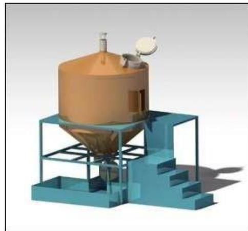
Gambar 5.b Tungku Pembakaran Hasil Perancangan
