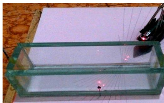
Gambar 4. Penggunaan alat refraktometer dengan laser sebagai sinar datang (Alat B)
