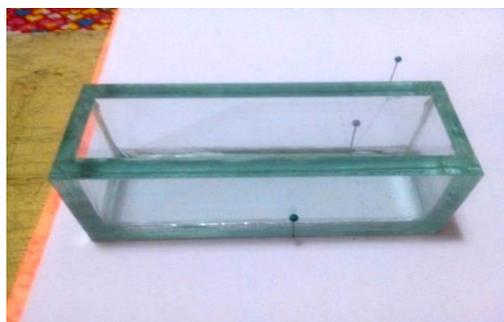
Gambar 3. Penggunaan Alat refraktometer dengan jarum pentul sebagai sinar datang (Alat A)
