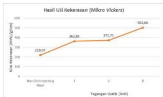
Gambar 2. Pengaruh tegangan listrik elektroplating nikel terhadap kekerasan
