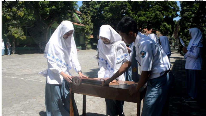
Gambar 10. Meletakkan Klinometer Fleksibel secara Mendatar
