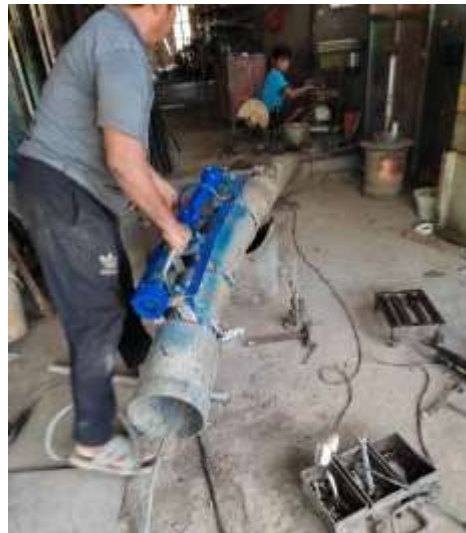
Gambar 5. Pembuatan pipa pompa
