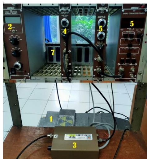
Gambar 1. Peralatan eksperimen Spektroskopi Gamma di Lab. Fisika Atom Inti, UGM
