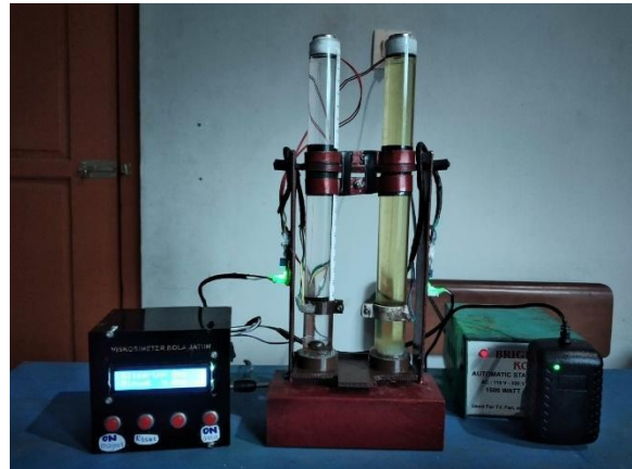
Gambar 4. Alat Peraga Peraga Viskositas Berbasis Mikrokontroler
