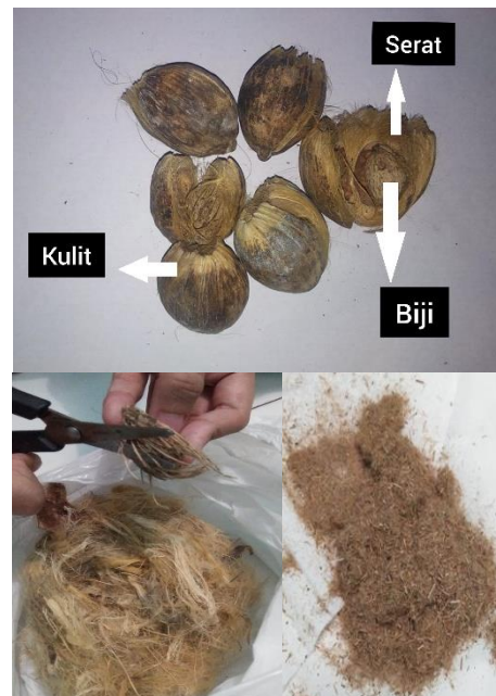
Gambar 1 Proses pemisahan serat dari kulit pinang.
