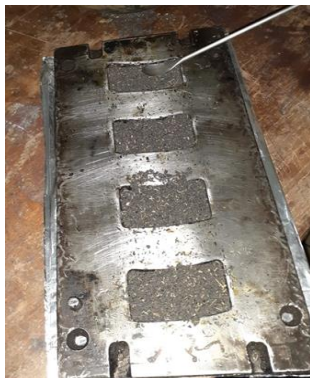
Gambar 2. Proses pencetakan kampas rem.
