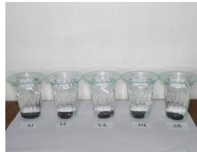
Gambar 3 Uji serapan air kampas rem.
